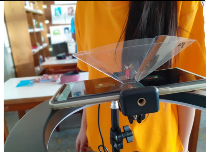
錄製完成後，立即開啟全息投影APP並擺放透明片，便可以出現立體影像。
